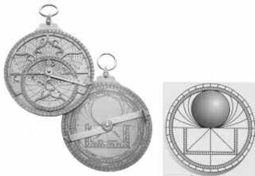
Fig. 13 - Fronte e dorso di un astrolabio piano tedesco in ottone circondato dalla scala dei gradi di latitudine, completo di alidada girevole, del tipo costruito da Christoph Schissler (Augsburg, 1560). Il disco di latitudine dal quale la costruzione grafica di questo astrolabio è stata sviluppata segna il circolo del 48° parallelo N dalla linea dell'Equatore. A destra, ricostruzione della sfera della Terra inquadrata nella meridiana con le linee orarie, quadrato delle ombre e scala dei gradi incisi sul dorso dell'astrolabio (ricostruzione di Martin Brunold)
