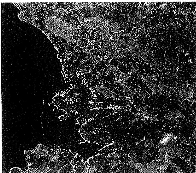
Fig. 9 - Sovrapposizione del layer vettoriale degli edifici sull'immagine della classificazione combinata C°/NDVI (fig. 5).
