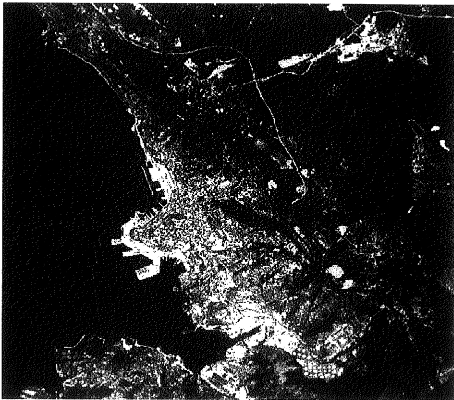
Fig. 1 - Immagine del satellite Landsat 7 relativa al Comune di Trieste e suoi immediati circondari. Composizione a colori veri (rosso: banda 3; verde: banda 2; blu: banda 1). Georiferita in Gauss-Boaga, fuso est, sferoide internazionale 1909, datum Roma 1940.
