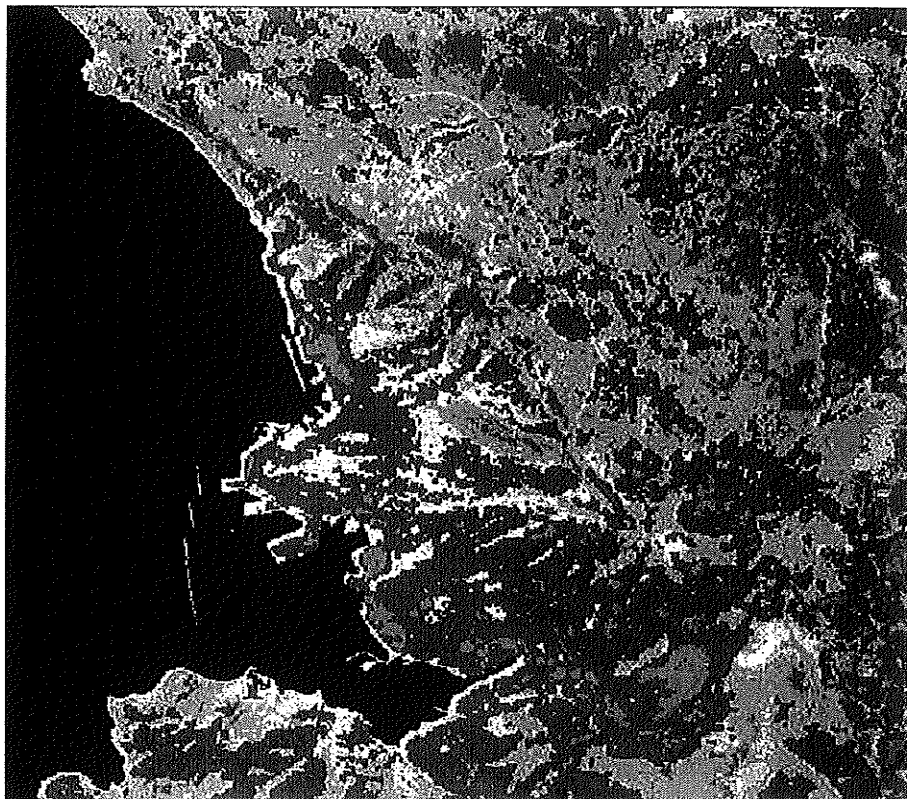
Fig. 5 - Classificazione su tutte le possibili combinazioni di categorie che risultano dalla sovrapposizione delle due immagini di fig. 3 (temperature e indice di vegetazione NDVI).
