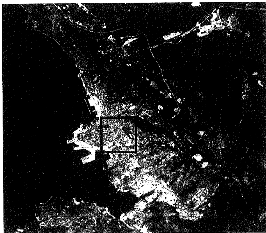
Fig. 4 - Area del Comune di Trieste nella quale si sono indagati i valori dei pixel per le temperature e l'indice di vegetazione NDVI. L'area triestina di cui si sono analizzati i valori dei pixel (temperatura in C° e valore NDVI) è evidenziata in nero.
